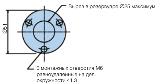
Стержень стандартного навинчиваемого сапуна
