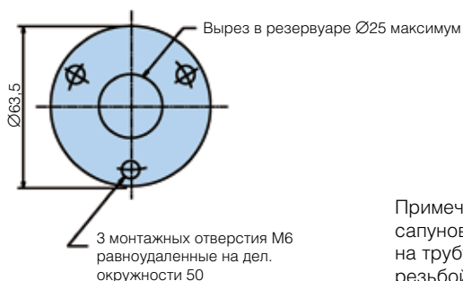
Стержень навинчиваемого сапуна для баков под давлением
